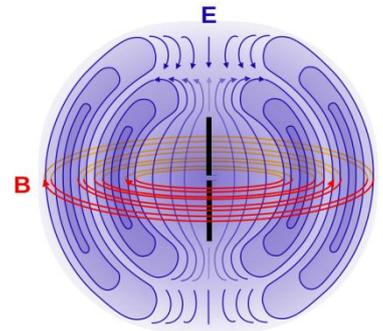
Resistência de radiação -  $R_{rad} = 2 \frac{P_{med}}{I^2} = \eta_0 \frac{2\pi d^2}{3 \lambda^2}$
