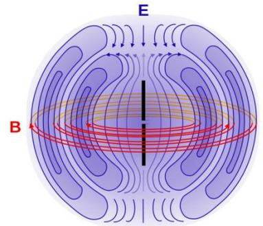
Resistência de radiação -  $R_{rad} = 2 \frac{P_{med}}{I^2} = \eta_0 \frac{2\pi}{3} \frac{d^2}{\lambda^2}$
