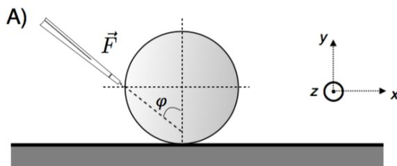
direita, girando como indicado na figura B até um instante  $t_D$  medido a partir do início do movimento. A partir desse instante de tempo, a bola começa a deslizar, sem girar, sobre a mesa até o instante  $t_R$ , a partir do qual começa a rolar sem deslizar. O coeficiente de atrito entre a bola e a mesa é  $\mu$ .
