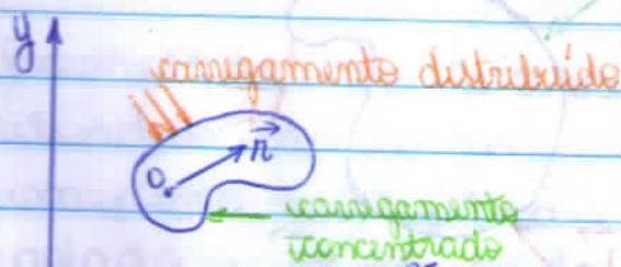
Para uma estrutura bidimensional pertencente ao plano xy, repare que os carregamentos e o vetor peso também pertencem a esse plano. O momento é ortogonal a xy ( $\vec{M}_0 = M_0 \vec{k}$ ).
